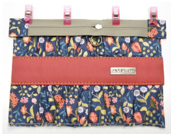
obr.14 Zip leží na látce zoubky dolů. Okraj zipového pásu kopíruje horní okraj látky.
