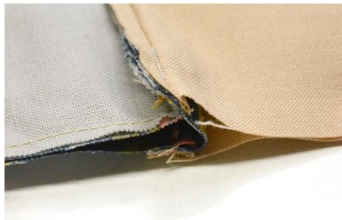
obr.18 Látková koncovka směřuje do podšívky, ŠP k vnějším dílům.
